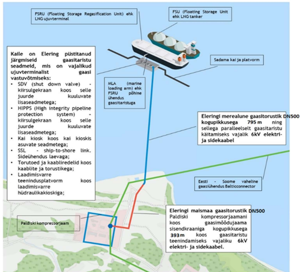
Joonis 3.5 Pakrineeme FSRU haalamiskai plaan
