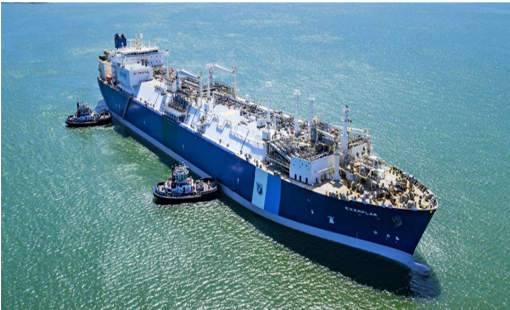
Joonis 3.3 LNG taasgaasistamise võimekusega LNG tanker (FSRU)
