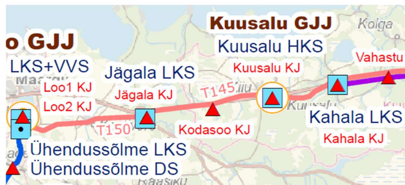
Joonis 4.15 Ühendussõlme-Kahala DN500 torulõik
