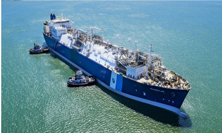
Joonis 3.3 LNG taasgaasistamise võimekusega LNG tanker (FSRU)
